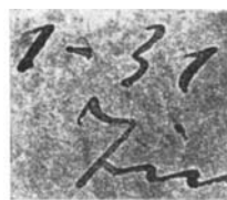
Abb. 8. Hanikirsch-Reaktion auf Sulfatwanderung bei einer zwei Jahre alten Eisengallustinte.
